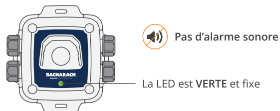
Figure 4-3 - Inspection des détecteurs de gaz MGS-410 connectés
