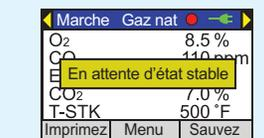
\* Si l'état stable n'est pas atteint, l'équipement de combustion peut nécessiter une mise au point majeure, des réparations majeures ou un remplacement.
