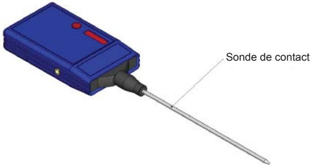
L'accessoire breveté « Touch Probe » (sonde de contact) est un dispositif qui convertit un bruit solide en bruit aérien que le Tru Pointe® Ultra HD peut détecter. Par exemple, le bruit d'une fuite interne dans une vanne d'eau circulera vers sa surface. Toucher la surface de la vanne avec la sonde de contact transfèrera les ultrasons dans la sonde et les convertira en ultrasons aériens. Installation de la sonde de contact :
