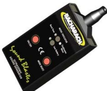
Certains kits Tru Pointe® Ultra HD comprennent le générateur d'ultrasons de Bacharach, le SoundBlaster®. Le SoundBlaster® est utilisé pour pressuriser artificiellement des éléments et détecter les fuites potentielle à l'aide d'une tonalité ultrasonique de 115 dB. Le Tru Pointe® Ultra HD peut détecter la tonalité car elle s'échappe dans des zones qui ne sont pas sous pression.
