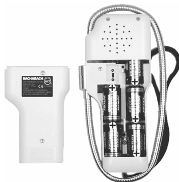
Figure 2. Installation de la batterie
